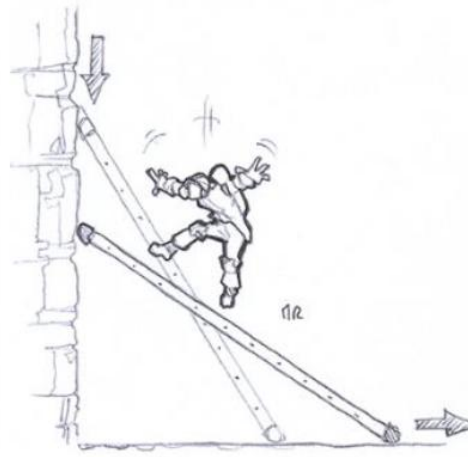
Échelle trop inclinée © Matthieu Robert
